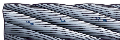
fils cassés au niveau des "parures"
